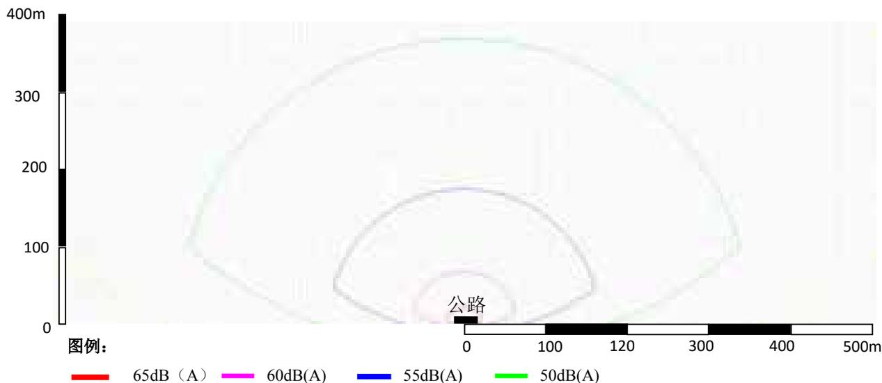
图 4.4-12 沙头连接线营运远期昼间噪声垂直方向等声值线图
