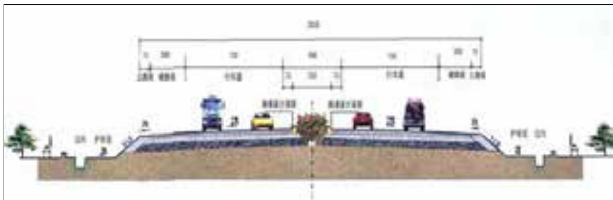
图 2.2-1 主线路基横断面图（路基宽 26.5m）
