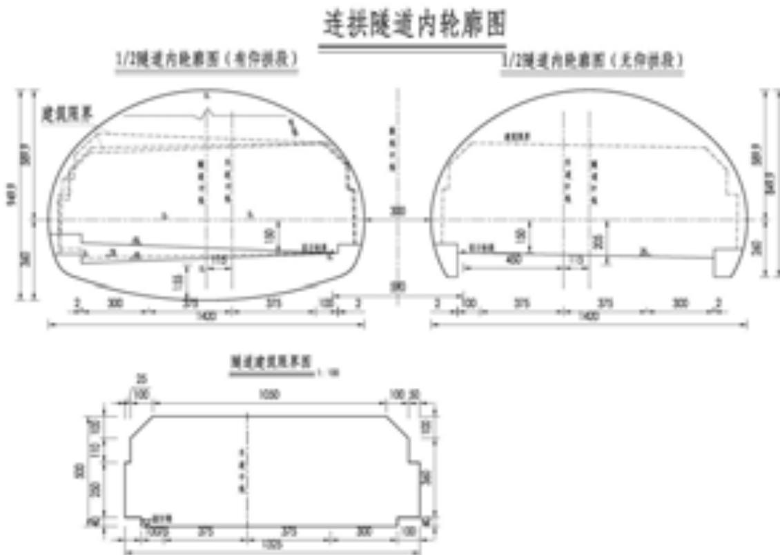
图 2.2-3 短隧道标准断面图 (120km/h)
