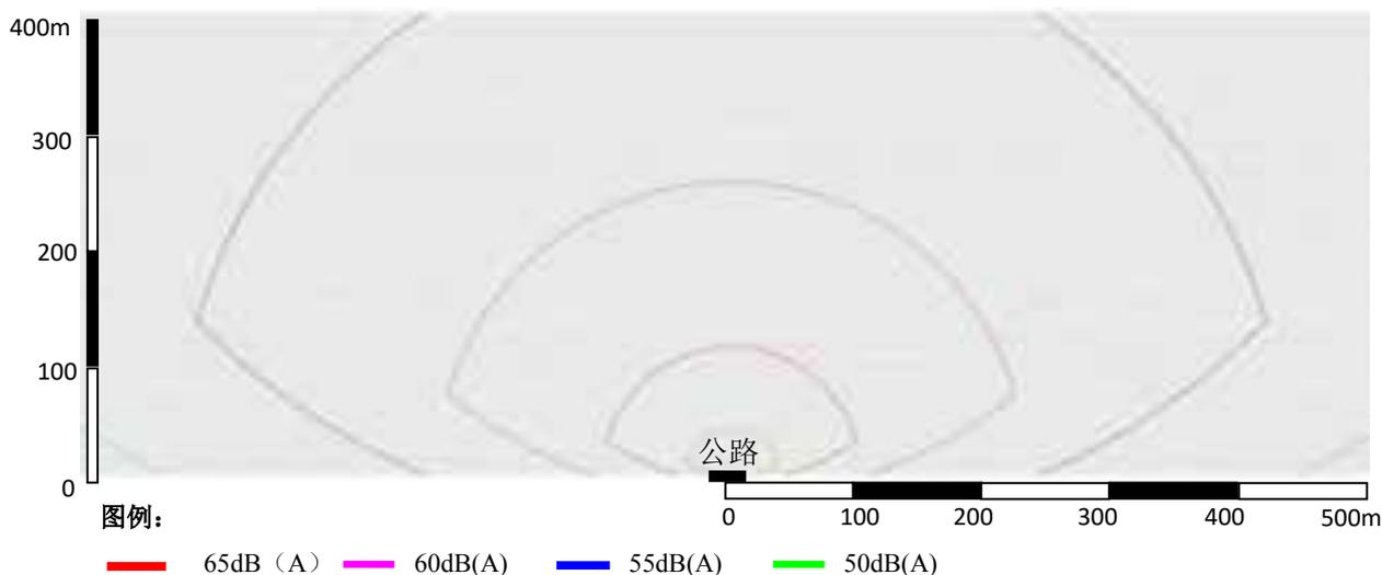
图 4.4-10 主线苍梧-梨埠段营运远期昼间噪声垂直方向等声值线图
